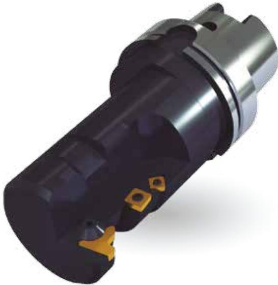
Herramienta rotativa combinada con cuerpo excéntrico para placa perfilada con forma, mandrinado con sistema de regulación radial y achaflanado.
