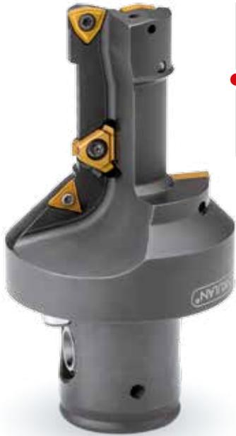
Herramienta rotativa combinada para la ejecución de pretaladrado desbaste, acabado de precisión, lamado y achaflanado + ranurado por interpolación con placa perfilada.
