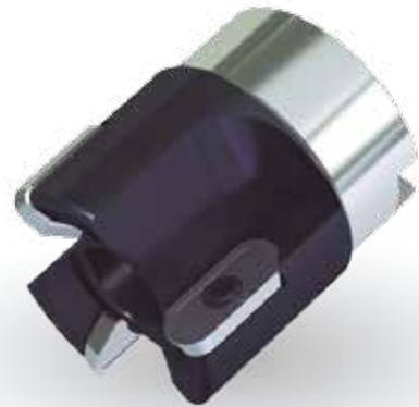
Plato Ø 25 monoblock diseñado para la mecanización de aluminio a altas revoluciones. Posibilidad de diseñarlo para cualquier placa de cualquier fabricante. Equilibrado en G6,3. Sistema de amarre: HSK-B63.
