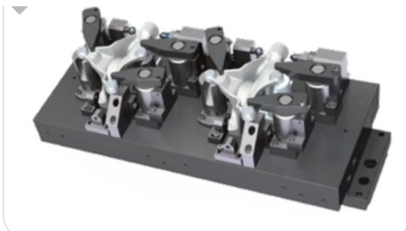
diseña los dispositivos de sujeción tanto hidráulicos como de accionamiento manual que mejor se adaptan a las necesidades de cada caso.
